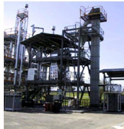
I gassificatori sono impianti che sfruttano la dissociazione molecolare, definita pirolisi, usata per convertire direttamente i materiali organici quali ad esempio scarti di cartiera, pneumatici, plastiche, biomasse (scarti vegetali, legno, sansa di olive ecc), in gas mediante riscaldamento in presenza di ridotte quantità di ossigeno.
